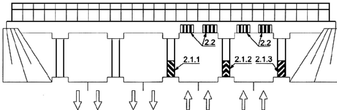
Рисунок В.20 - Пример нанесения разметки 2.1 и 2.2
