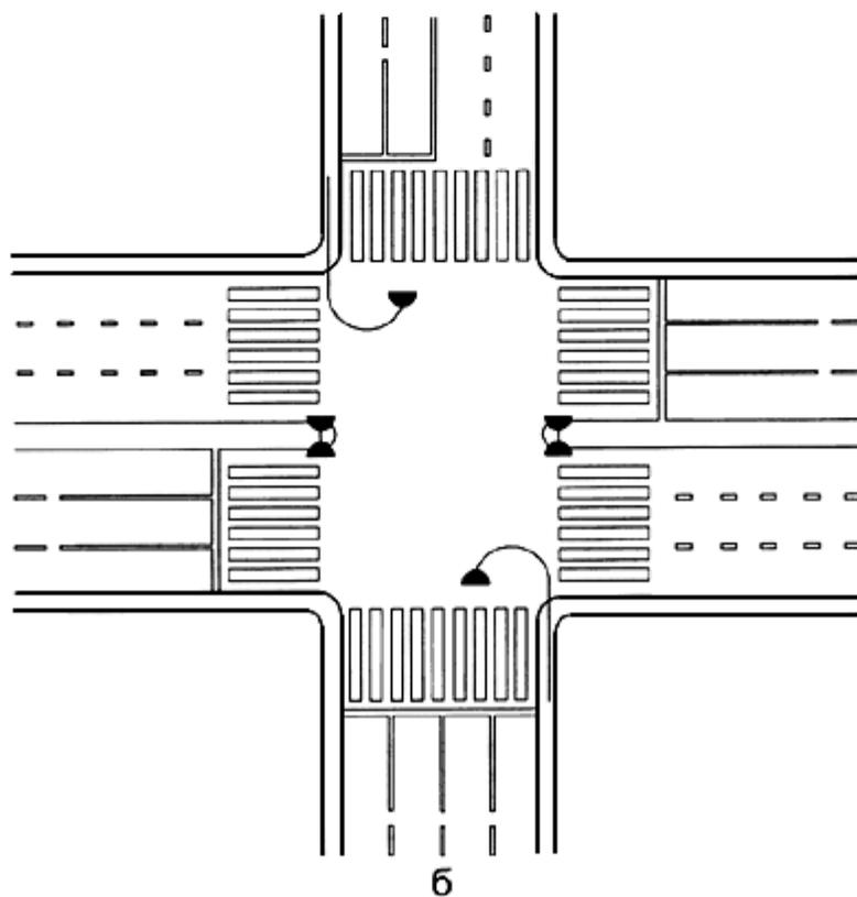
Рисунок В.24 - Пример размещения светофоров:
